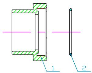
Внутри резьбовой разъем сварного шва
